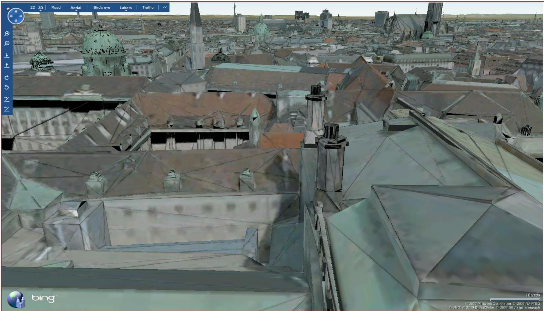
Automatisierte Ermittlung der Gebäudegeometrie inkl. Mapping der Luftaufnahmen
